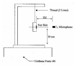
1 METER FROM MICROPHONE TO FAN INTAKE
