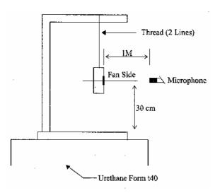
1 METER FROM MICROPHONE TO FAN INTAKE
