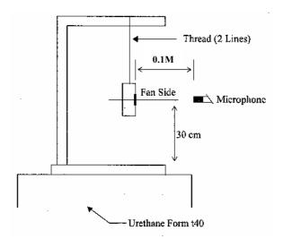
0.1 METER FROM MICROPHONE TO FAN INTAKE
