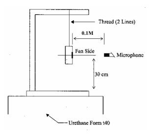
0.1 METER FROM MICROPHONE TO FAN INTAKE
