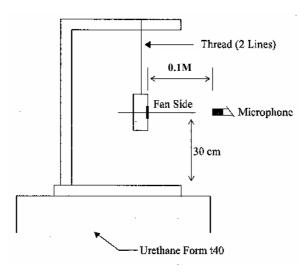
0.1 METER FROM MICROPHONE TO FAN INTAKE
