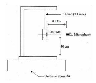
0.1 METER FROM MICROPHONE TO FAN INTAKE
