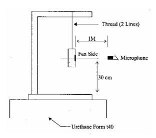
1 METER FROM MICROPHONE TO FAN INTAKE
