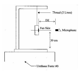
1 METER FROM MICROPHONE TO FAN INTAKE
