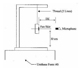
1 METER FROM MICROPHONE TO FAN INTAKE
