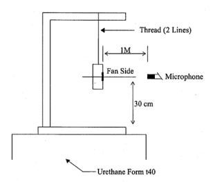
1 METER FROM MICROPHONE TO FAN INTAKE
