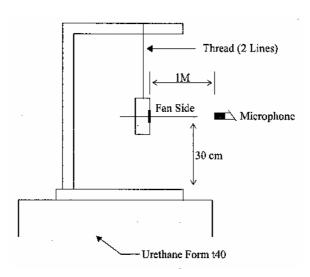
1 METER FROM MICROPHONE TO FAN INTAKE
