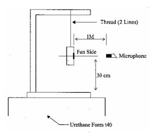
1 METER FROM MICROPHONE TO FAN INTAKE
