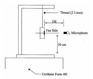
1 METER FROM MICROPHONE TO FAN INTAKE
