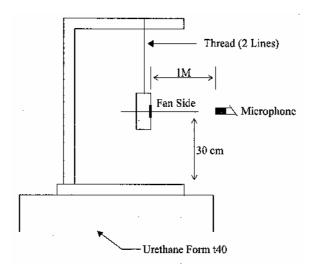
1 METER FROM MICROPHONE TO FAN INTAKE
