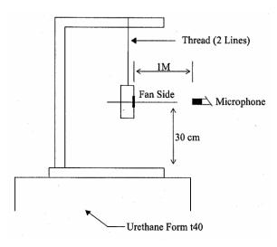
1 METER FROM MICROPHONE TO FAN INTAKE
