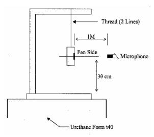
1 METER FROM MICROPHONE TO FAN INTAKE
