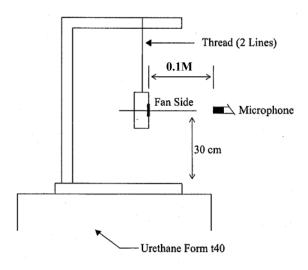
0.1 METER FROM MICROPHONE TO FAN INTAKE
