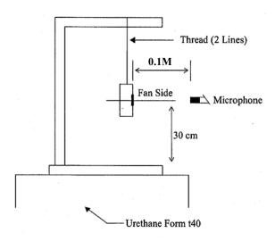
0.1 METER FROM MICROPHONE TO FAN INTAKE
