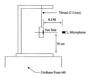
0.1 METER FROM MICROPHONE TO FAN INTAKE
