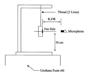
0.1 METER FROM MICROPHONE TO FAN INTAKE
