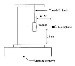
0.1 METER FROM MICROPHONE TO FAN INTAKE
