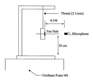
0.1 METER FROM MICROPHONE TO FAN INTAKE
