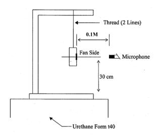
0.1 METER FROM MICROPHONE TO FAN INTAKE
