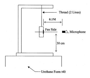
0.1 METER FROM MICROPHONE TO FAN INTAKE
