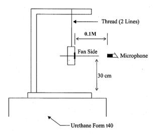
0.1 METER FROM MICROPHONE TO FAN INTAKE
