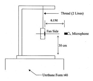
0.1 METER FROM MICROPHONE TO FAN INTAKE
