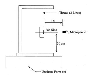
1 METER FROM MICROPHONE TO FAN INTAKE
