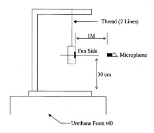
1 METER FROM MICROPHONE TO FAN INTAKE
