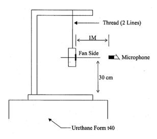
1 METER FROM MICROPHONE TO FAN INTAKE
