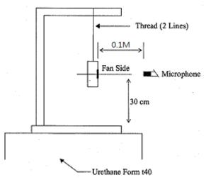
0.1 METER FROM MICROPHONE TO FAN INTAKE
