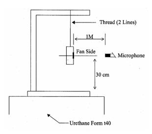
1 METER FROM MICROPHONE TO FAN INTAKE
