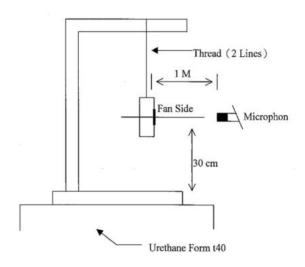
1 METER FROM MICROPHONE TO FAN INTAKE
