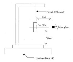
1 METER FROM MICROPHONE TO FAN INTAKE
