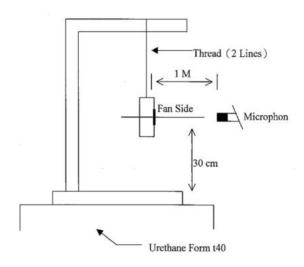
1 METER FROM MICROPHONE TO FAN INTAKE
