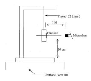
1 METER FROM MICROPHONE TO FAN INTAKE
