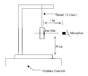
1 METER FROM MICROPHONE TO FAN INTAKE
