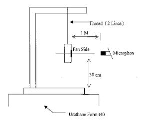
1 METER FROM MICROPHONE TO FAN INTAKE
