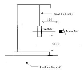
1 METER FROM MICROPHONE TO FAN INTAKE
