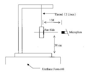
1 METER FROM MICROPHONE TO FAN INTAKE
