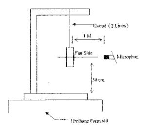
1 METER FROM MICROPHONE TO FAN INTAKE
