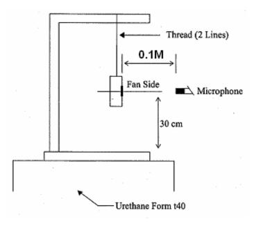
0.1 METER FROM MICROPHONE TO FAN INTAKE
