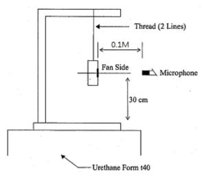
0.1 METER FROM MICROPHONE TO FAN INTAKE
