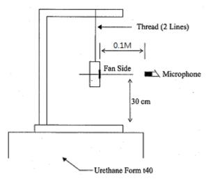
0.1 METER FROM MICROPHONE TO FAN INTAKE
