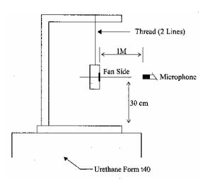
1 METER FROM MICROPHONE TO FAN INTAKE
