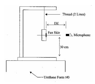
1 METER FROM MICROPHONE TO FAN INTAKE
