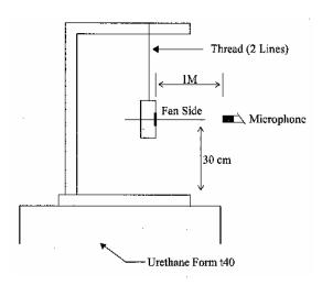
1 METER FROM MICROPHONE TO FAN INTAKE
