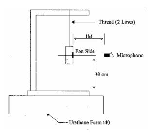
1 METER FROM MICROPHONE TO FAN INTAKE
