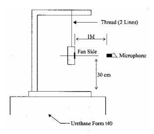
1 METER FROM MICROPHONE TO FAN INTAKE
