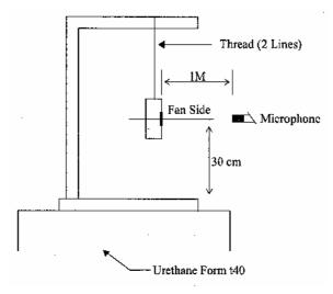
1 METER FROM MICROPHONE TO FAN INTAKE
