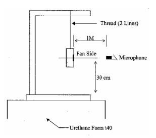
1 METER FROM MICROPHONE TO FAN INTAKE
